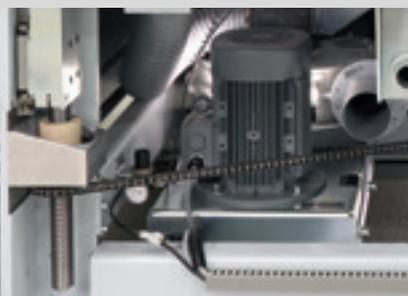
**Werkstückdickeneinstellung** durch vier Trapezgewindespindeln
